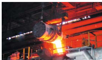
1. Плавильное отделение (десульфурация, доведение до заданного химического состава чугуна, модифицирование)
