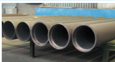
4. Отделение трубоотделки (первичный контроль качества, доработка труб)
