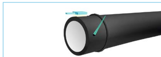
1. Очистка и смазка гладкого конца трубы
