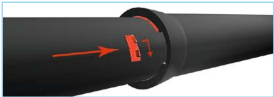
6. Стыковка труб и установка стопоров
