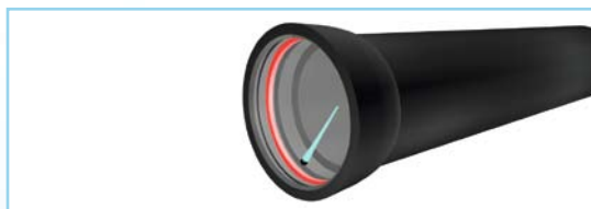
6. Смазка внутренней поверхности уплотнительного кольца
