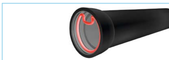
5. Установка уплотнительного кольца в раструб
