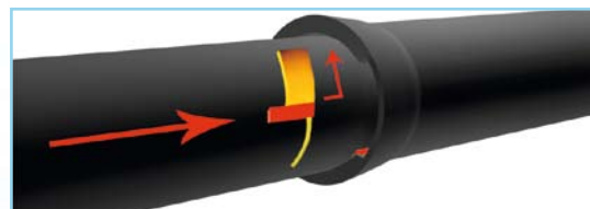
6. Установка левого стопора. Фиксация стопорной проволокой
