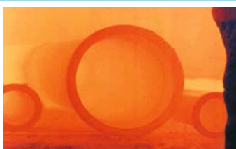
3. Термическое отделение (отжиг труб)
