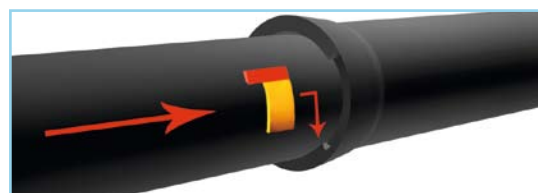
5. Стыковка труб и установка правого стопора
