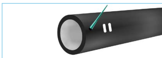
3. Смазка наружной поверхности гладкого конца трубы
