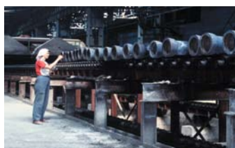
6. Участок нанесения цементно-песчаного покрытия
