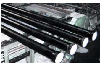
7. Участок нанесения наружного завершающего покрытия
