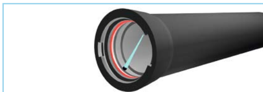
5. Смазка внутренней поверхности уплотнительного кольца
