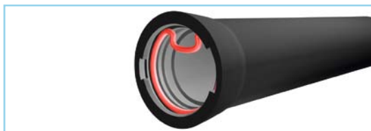
4. Установка уплотнительного кольца в раструб
