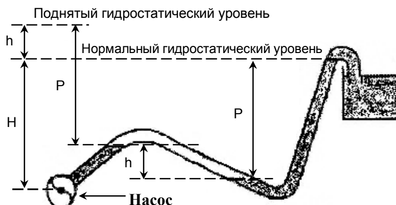
Рисунок 5.4 Условия в напорном трубопроводе.
