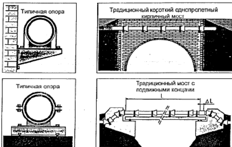
Рисунок 6.32 Трубопровод, закрепленный на сооружении.
