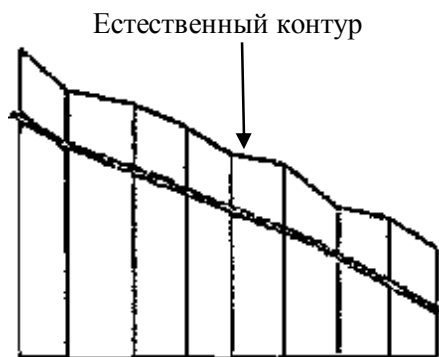
Рисунок 5.5 Трубопровод с постоянным уклоном.
