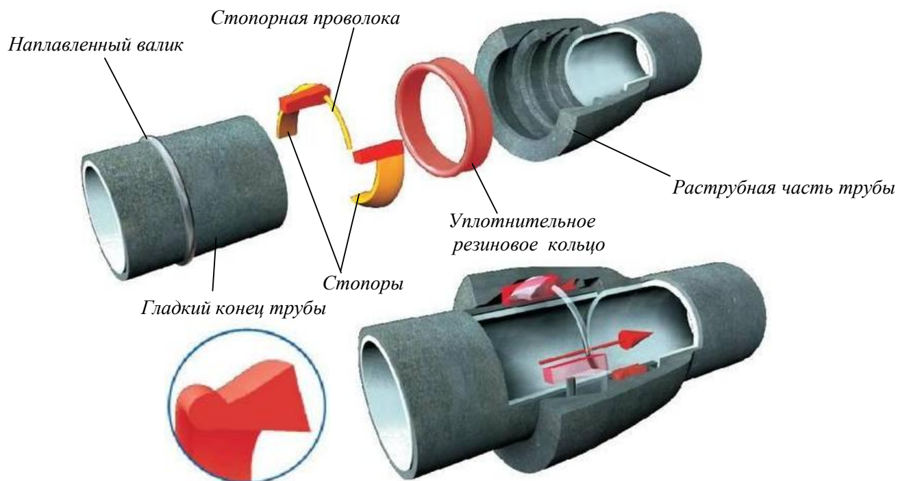
Рисунок 2.4 Раструбно-замковое соединение «RJ».
